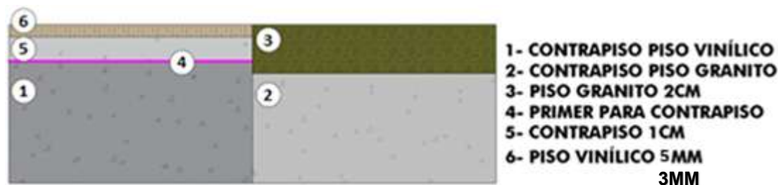
Figura 12 - Ordem de execução dos pisos e detalhe do encontro dos pisos
